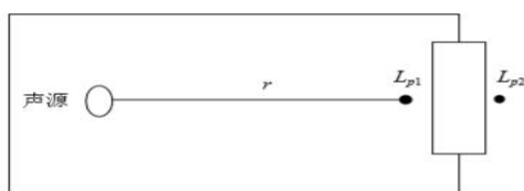
图 4-1 室内声源等效为室外声源图例
